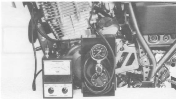
**要点** バキュームゲージの指針の振れが大きい時は、ダンパアジャスタを締め込み指針の動きを少し緩慢にする。余りダンパを効かせすぎるとゲージ値が低くなるので注意する。
